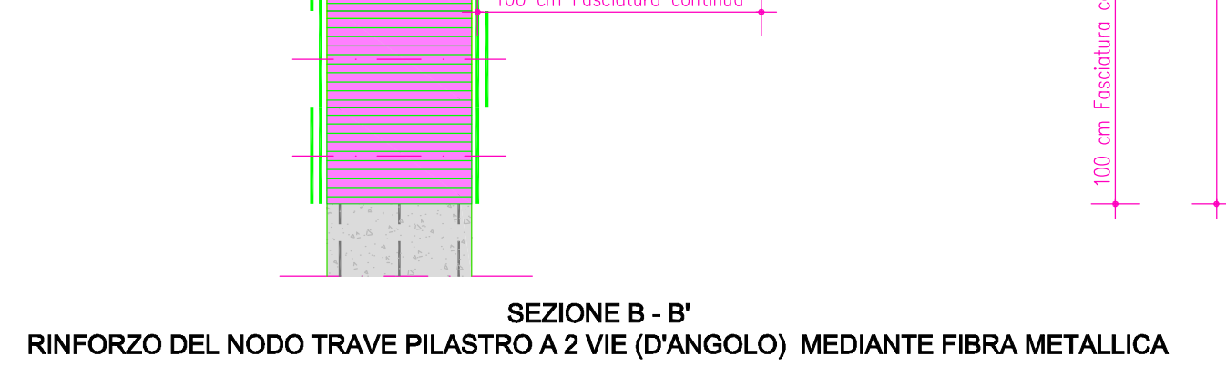
SEZIONE B - B' RINFORZO DEL NODO TRAVE PILASTRO A 2 VIE (D'ANGOLO) MEDIANTE FIBRA METALLICA
